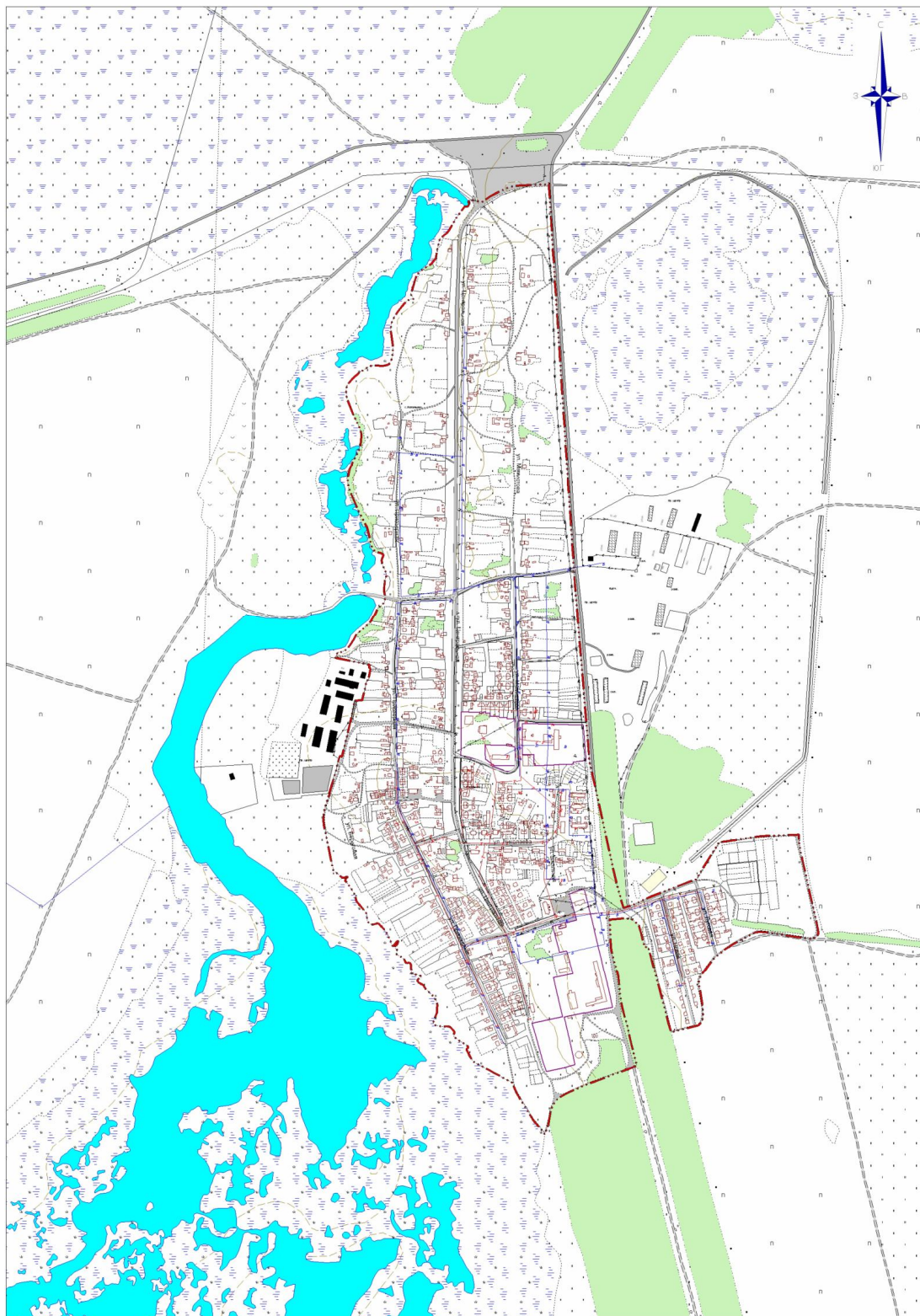
Схема водоснабжения с. Натальино (опорный план) М 1:5000
