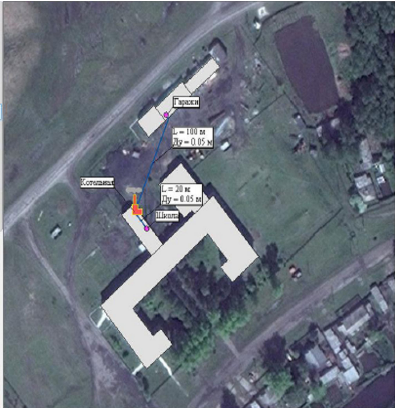
Рисунок 1 – Электронная схема системы теплоснабжения поселения
