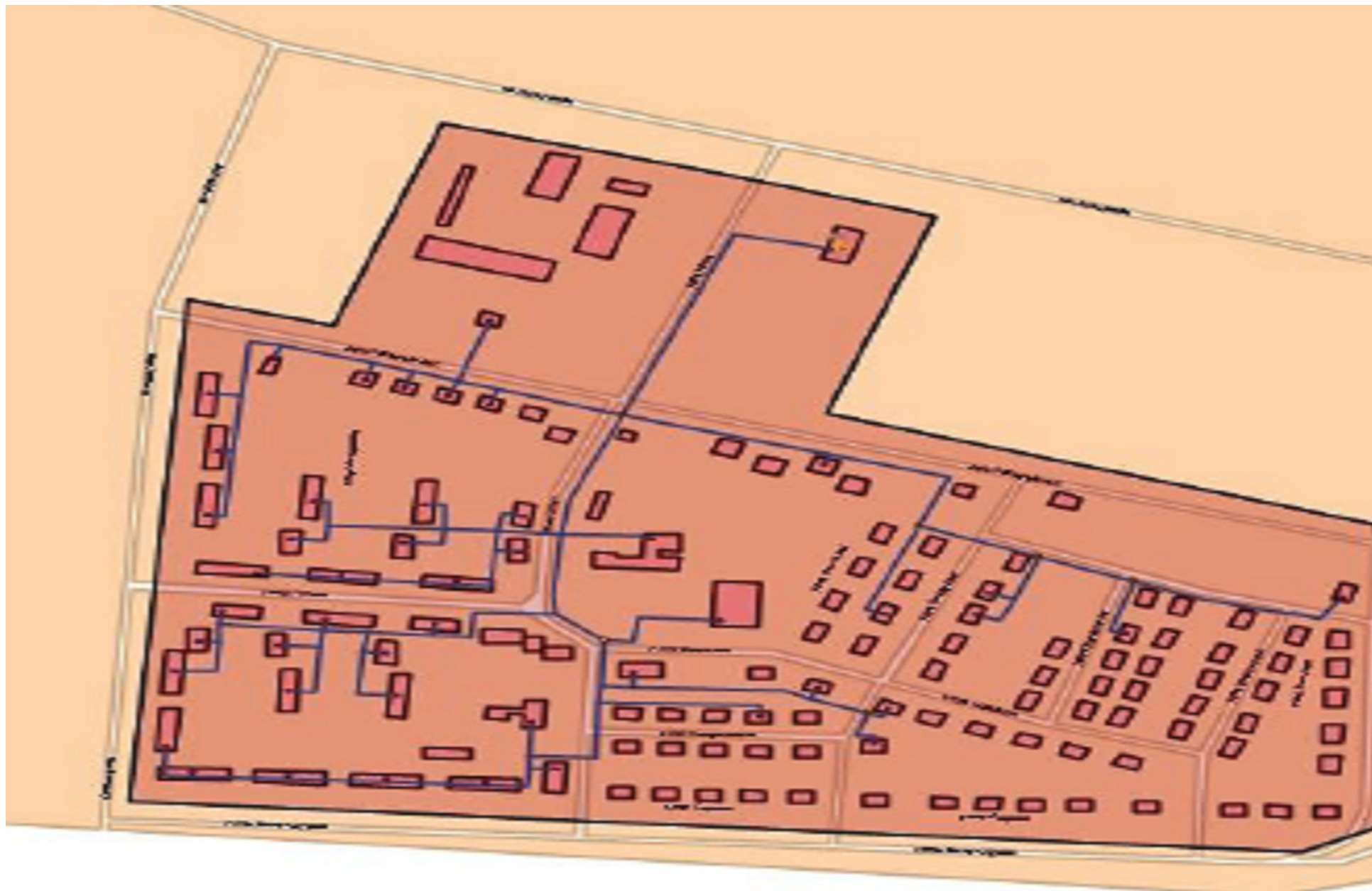
Рисунок № 3 - Схема тепловых сетей в зоне действия источника тепловой энергии с. Ольгино
